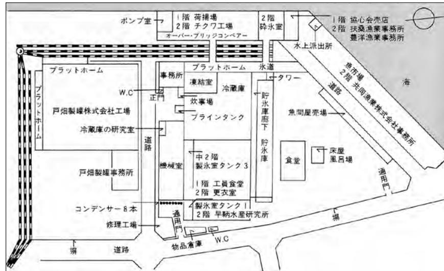
陸上施設は、4,500坪（1万5,000平方メートル）の敷地に、製氷・冷蔵工場1,500坪、荷揚げ場500坪、魚市場300坪、諸会社事務所400坪、魚糧工場300坪、製函工場300坪、研究所120坪が集積的に設置された。また、第1号上屋400坪はトロール船荷揚げ場、第2号上屋100坪は手繰船荷揚げ場であった。
